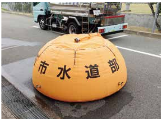
バルーン型仮設応急給水槽
