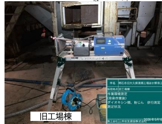
⑤ ダイオキシン類除染工事完了後 管理区域内 作業環境測定状況
