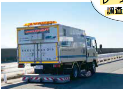
路面下の空洞調査
