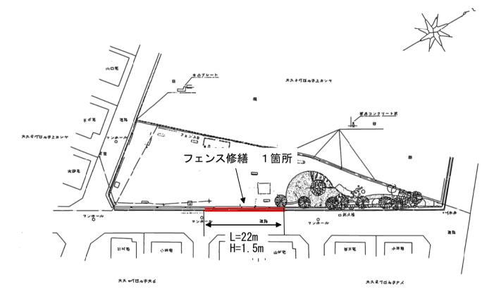
メッシュフェンス設置 (ARフェンス同等品以上) H=1.5m L=22m ※施工に支障となる木の根の伐根含む (伐採は市で対応)
