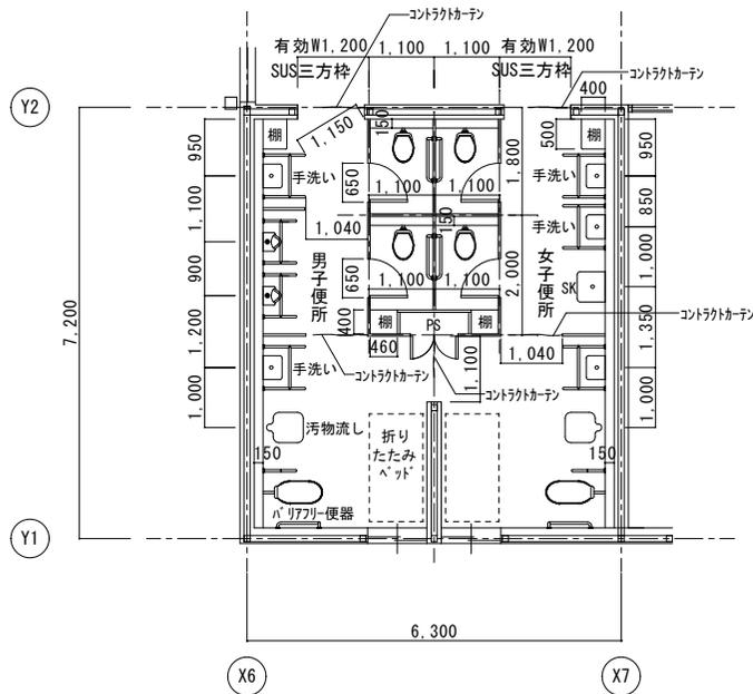
便所1,2階平面詳細図 S=1/100 ※施工図要提出
