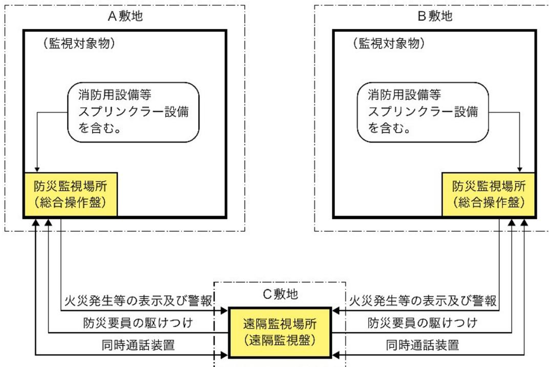
4 一の防火対象物の火災関連情報を複数の総合操作盤により監視・制御するシステムの例の例
