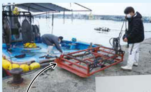
縦1.5m×横1.5m 鉄製の耕うん桁
